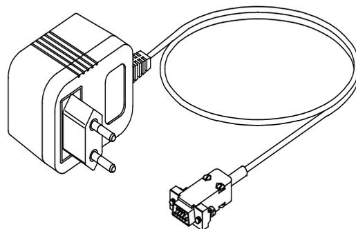
разъему уровнемера. Адаптер обеспечивает нормальные параметры процесса заряда, при напряжении сети от 190В до 240В. При этом на его выходе формируется напряжение постоянного тока 12В с пульсациями не более 1В при токе нагрузки не менее 1.5А.
