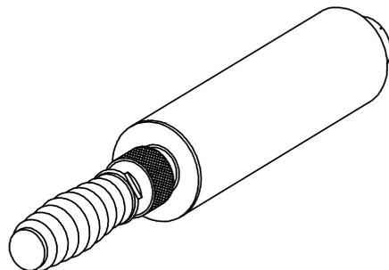
ГАИ-1 имеет резервуар для накопления избыточного давления воздуха, ручной насос, транспортный фиксатор и клапан для быстрого стравливания, которые объединены в едином конструктиве. (В ручке помещены запасные резиновые кольца для ГАИ-1)
