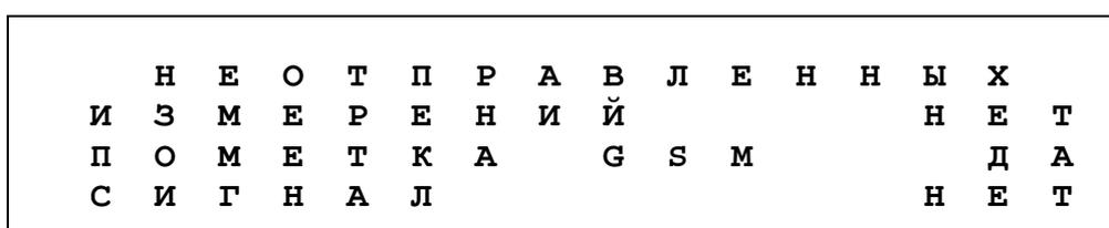
Для индикации амплитуды сигнала GSM установите символ «ДА», чтобы на дисплее появилась надпись «СИГНАЛ ДА».
