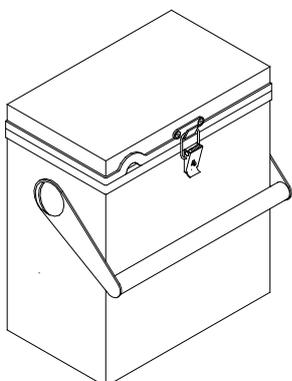
Внешний дополнительный аккумулятор БА-1 предназначен для питания уровнемера. БА-1 предназначен для работы при сильных морозах в зимних условиях, когда требуется непрерывная работа уровнемера (КВУ, КВД, вывод на режим) до нескольких суток или недель. БА-1 имеет в своем составе кислотный необслуживаемый аккумулятор с системой ограничения выходного тока, помещенного в ударопрочный металлический корпус.
