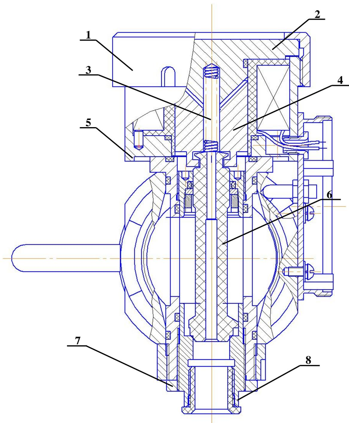
Для разборки клапанного узла необходимы ключи для круглых шлицевых гаек по ГОСТ 16984-71 или ключи шарнирные для круглых шлицевых гаек по ГОСТ 16985-71 для диаметров гаек 68 мм. и 87 мм. А также ключи гаечные рожковые 36 и 27 мм.
