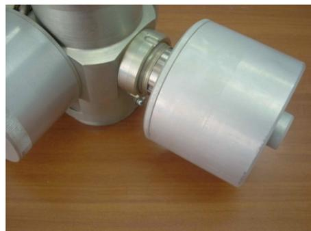
**Внимание! Вращать корпус уровнемера или ручной клапан, а также устанавливать ресивер допускается только при отсутствии давления в рабочем объеме уровнемера.**
