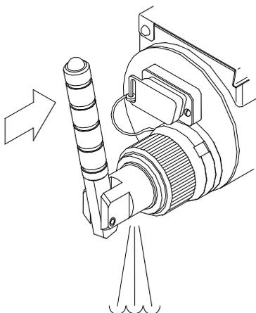
Далее уровнемер измерит амплитуду шума в скважине, в течение 0.5сек и автоматически (не надо нажимать на рукоятку ручного клапана) произведет генерацию акустического импульса. Во время измерения амплитуды шума на индикаторе индицируется надпись «АНАЛИЗ АМПЛИТУДЫ ШУМА».
