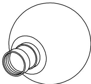
Шаровая насадка предназначена для формирования акустического воздействия при отсутствии избыточного давления газа в затрубном пространстве скважины. Шаровая насадка состоит из резиновой сферы и присоединительной муфты. Шаровая насадка приводится в действие резким ударом рукой по резиновой сфере и формирует акустический импульс, достаточный для уверенного контроля уровня жидкости в скважинах до (600...800)м. Шаровая насадка навинчивается на уровнемер вместо съемного ручного клапана.
